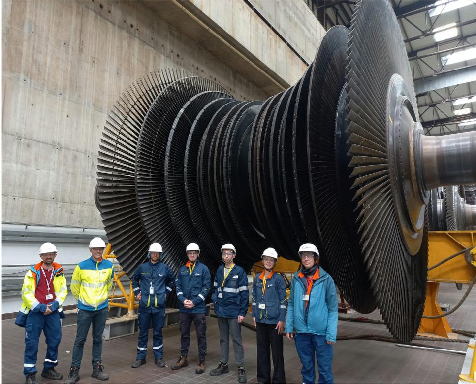
**Figure 10** – Rotor d'une Turbine BP
